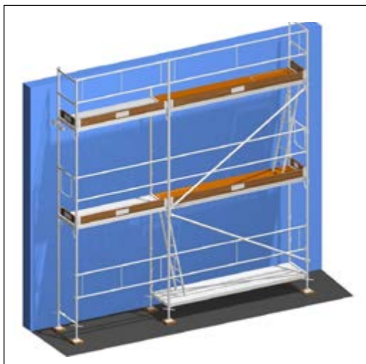
Figura 7. Ejemplo de andamio con las protecciones colectivas instaladas en los niveles de trabajo.
