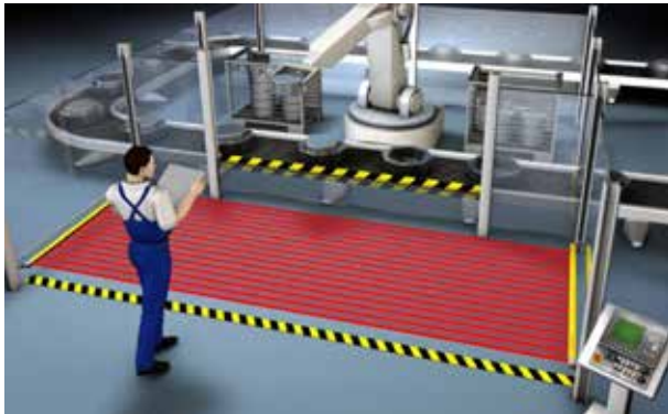
Figura 4. Cortina fotoeléctrica instalada en posición horizontal que permite detectar la presencia del operador en la zona peligrosa. Fuente: Leuze electronic S.A.U.
