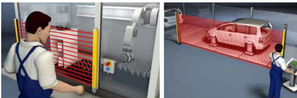
Figura 3. Cortina fotoeléctrica con función de parada que detiene las funciones peligrosas de la máquina antes de que sea posible alcanzar la zona peligrosa. Fuente: Leuze electronic S.A.U.
