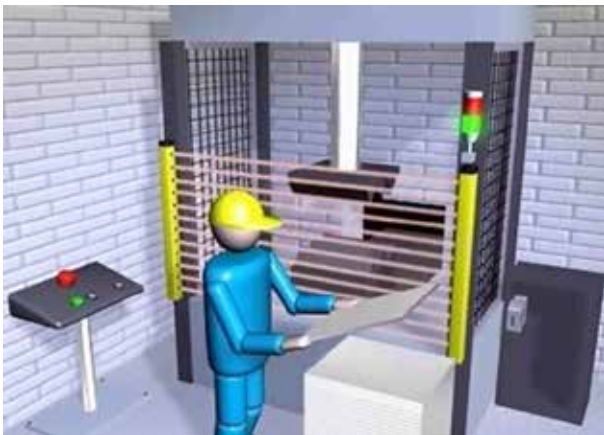
Figura 7. Función de puesta en marcha - una interrupción «un corte». Fuente: Leuze electronic S.A.U.
